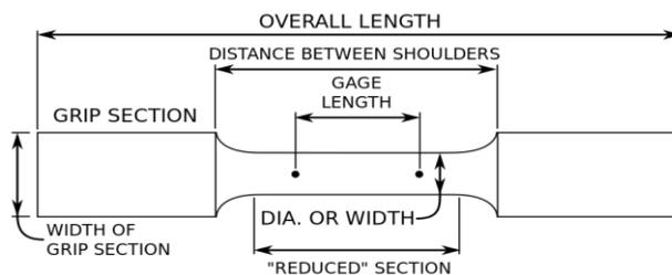
Fig.3 Tensile Specimen nomenclature
